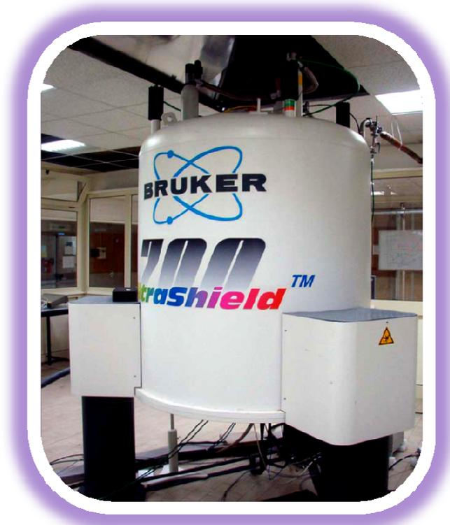
La configurazione sperimentale conosciuta col nome di “Magic Angle Spinning”, consente di ottenere degli spettri NMR ad altissima risoluzione anche su pochissime quantità di campione (nell’ordine di 50  $\mu\text{l}$ ) in fase semi liquida.
